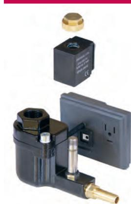
Entretien du SMART-GUARD-MINI ne pouvait pas être plus facile. Le drain se détache en dévissant les deux vis. Vous soulevez la bobine de la tige de valve et vous avez accès direct ensemble de soupape.
