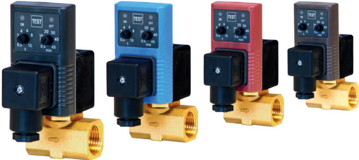
El EAD purgador temporizado económico, es una combinación de una válvula solenoide y un temporizador electrónico, diseñado para remover condensado automáticamente de los sistemas de aire comprimido.
