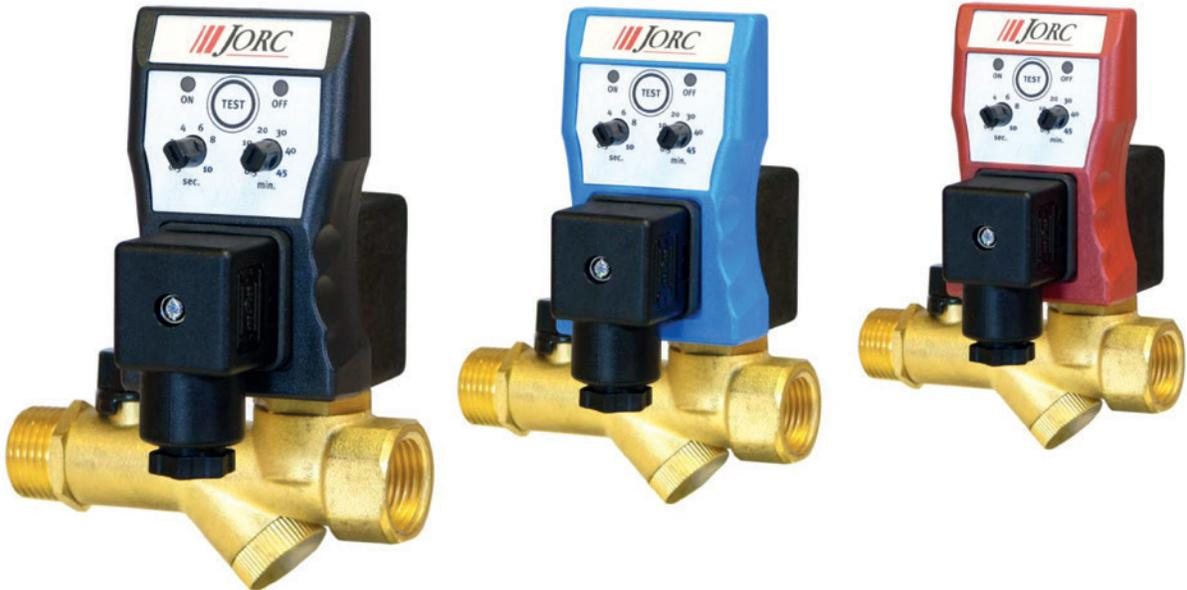
El COMBO purgador temporizado premium con válvula y filtro integrado, es una combinación de una válvula solenoide y un temporizador electrónico, diseñado para remover condensado automáticamente de los sistemas de aire comprimido.
