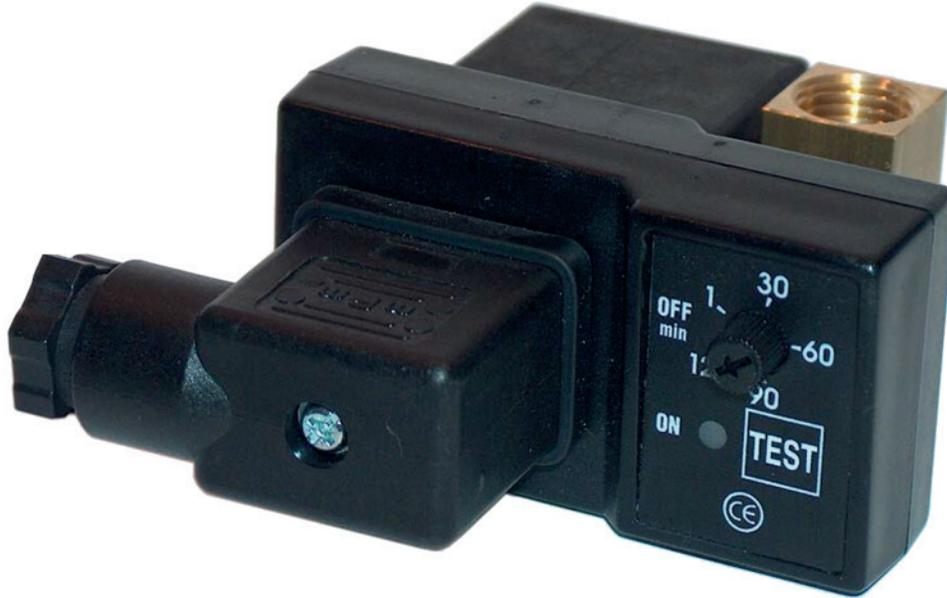
El TEC-11, purgador temporizado, es una combinación de una válvula solenoide y un temporizador electrónico, diseñado para remover condensado automáticamente de los filtros de aire comprimido y los pequeños compresores dentales libre de aceite hasta 230 PSI.
