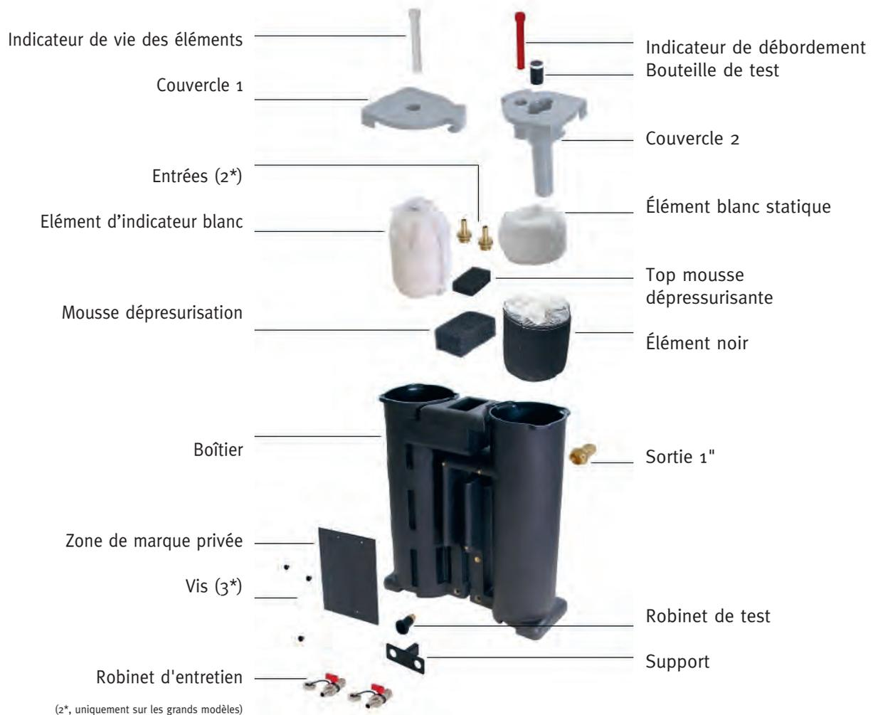
**Les modèles SEPREAMIUM 350 à 2500 sont équipés des robinets à double service offrant des possibilités de drainage séparés dans les tours.**
