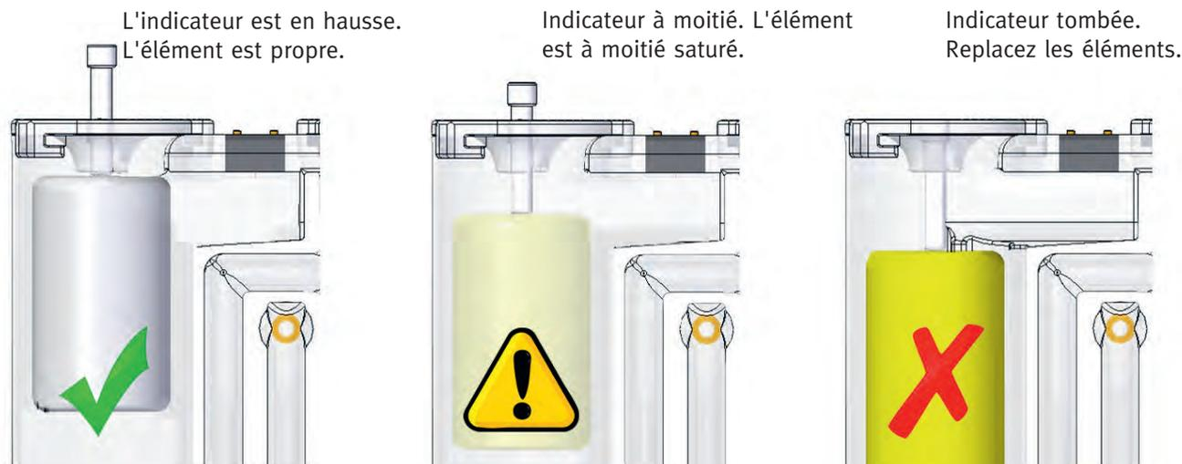
Une caractéristique unique des séparateurs SEPREMIUM est l'indicateur de durée de vie de l'élément (blanc). Cet indicateur donne une confirmation visuelle instantanée de la condition des éléments dans le séparateur et du moment où ils doivent être remplacés.
