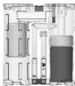
4. El indicador rojo (de desbordamiento) subirá en cuanto el nivel del agua en el separador sea demasiado alto, pues el indicador le informa que hay una posibilidad que el agua no puede pasar por los elementos (i.e. por medio de elementos saturados).
