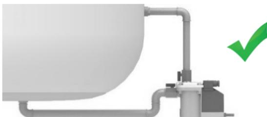
При установке дополнительных переходников или трубопроводов не следует уменьшать диаметр подающего трубопровода, т.к. это может привести к образованию воздушных пробок.
