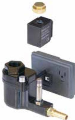
Mantener el SMART-GUARD-MINI no puede ser más fácil. La purga se puede desmontar por medio de destornillar dos tornillos después puede soltar la bobina para tener acceso inmediato a las partes internas de la válvula.
