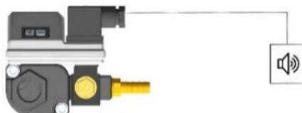
3. Reliez votre dispositif d'alarme à une alimentation d'énergie. Le commutateur d'alarme est de type «contact». Une alimentation d'énergie externe est nécessaire parce que le point de raccordement d'alarme fonctionne seulement.
