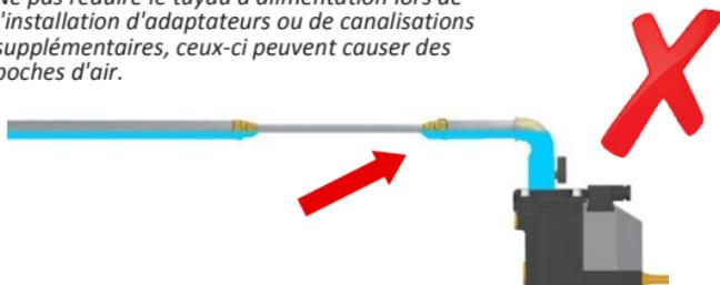
Nous conseillons l'installation de matériels suivants : tuyau d'évacuation des condensats diamètre 1/2", coude à 90° G1/2" et une conduite d'équilibrage 1/2" afin d'éviter la création d'une poche d'air.
