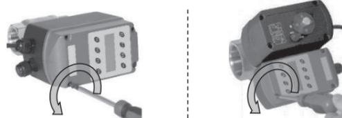
2. Retire la pila con cuidado usando un destornillador pequeño.
