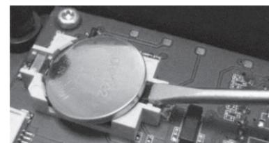
3. Insérez délicatement la nouvelle pile. Glissez-la dans le compartiment à pile (1) puis poussez-la vers le bas (2) jusqu'à entendre un clic.
