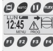
3. Appuyez sur AUTO pour revenir au cycle ouvrir/fermer programmé. L'unité revient alors aux cycles programmés et le rétroéclairage reprend à sa couleur normale.
