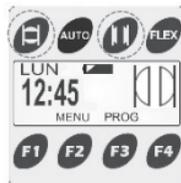
2. En appuyant sur le bouton d'OUVERTURE DE LA VANNE ou de FERMETURE DE LA VANNE vous suspendez le programme AUTO de manière permanente.
