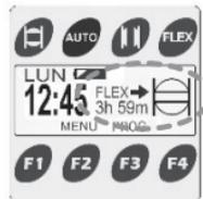
10. L'unité revient automatiquement aux paramètres programmés dès la sortie du mode FLEX.
