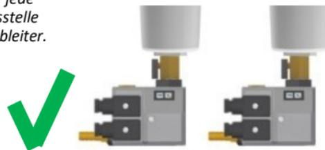
Vermeiden Sie Wassersäcke bei der Installation des Ablaufrohres. Hierdurch kann sich einen Luftpolster bilden.
