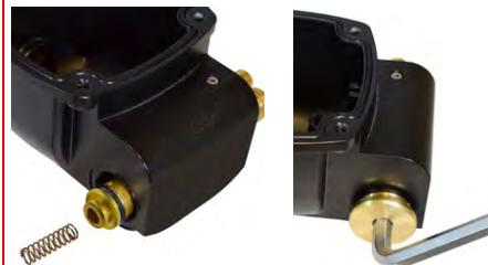
11. Верните клапан управляющего устройства на место и затяните его с помощью гаечного ключа на 13 мм (максимальный момент затяжки - 7 Нм).
