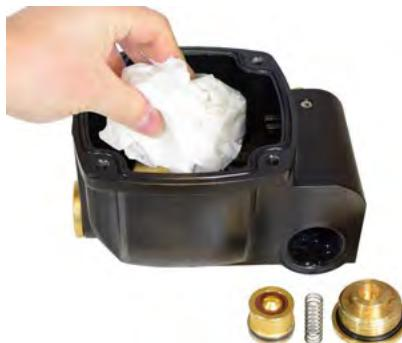
10. Верните фильтр и клапан на место в нижней части корпуса и прикрутите заглушки, используя шестигранный ключ на 10 мм (максимальный момент затяжки 10 Нм).
