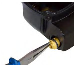
9. Почистите нижнюю часть корпуса, фильтр и детали клапана.
