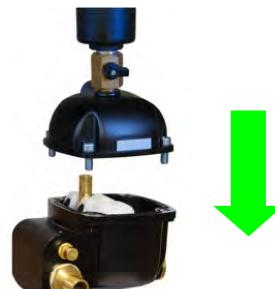
6. Открутите клапан управляющего устройства от нижней части корпуса, используя ключ на 13 мм. Почистите все детали клапана управляющего устройства. Положите его в безопасное место во избежание повреждений.
