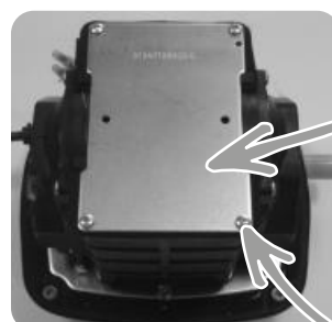
Prato da cobertura
