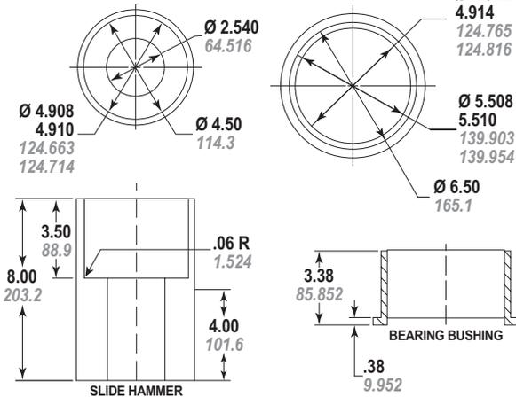
FIGURE 18 — SLEEVE & SPROCKET INSTALLATION TOOL
