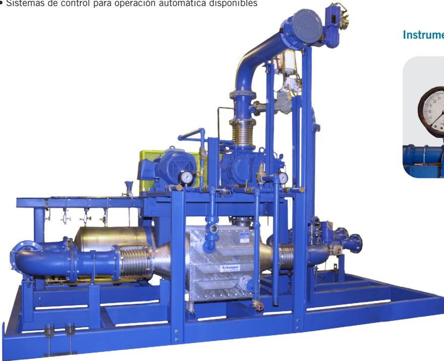
M-D Pneumatics puede suministrar paquetes personalizados con sopladores de dos etapas, impulsores de alto vacío, sistemas de inyección de líquidos y mucho más.
