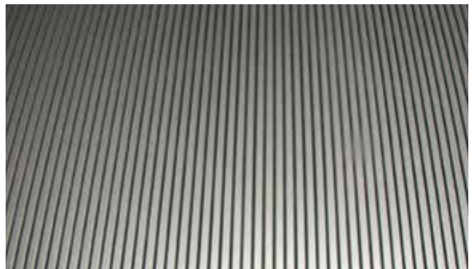
Superficie del rodillo ranurado 2,5 años después de la instalación del RS AirBlade. Las ranuras permanecen completamente limpias.
