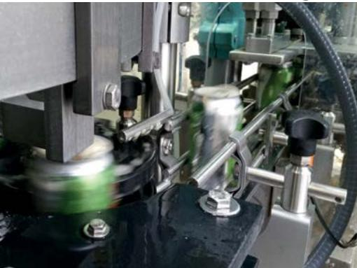
proporcionou aumento significativo em potência, e exigia que a operação fosse feita em um ciclo contínuo. A bomba usava um impelidor para sugar a cerveja e então despejá-la no preenchedor. O líquido era então transferido para latas de 355ml e 473ml.
