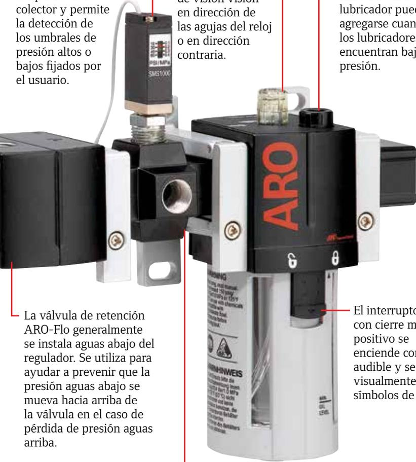
La válvula de retención ARO-Flo generalmente se instala aguas abajo del regulador. Se utiliza para ayudar a prevenir que la presión aguas abajo se mueva hacia arriba de la válvula en el caso de pérdida de presión aguas arriba.
