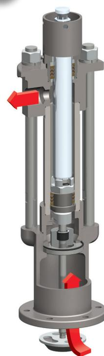
Die Schwergewichte der Serie – Schöpfkolbenpumpen von ARO® eignen sich für mittel- bis hochviskose Flüssigkeiten von 15.000 bis über 1.000.000 cP mit einer Förderleistung von bis zu 46,3 l/min.
