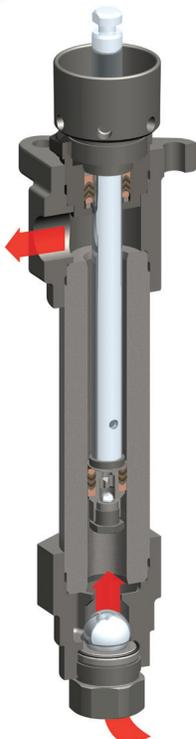
2-Kugel-Pumpen gehören zu den vielseitigsten ARO®-Produkten. Sie eignen sich für zahlreiche Anwendungen von der einfachen Übertragung bis zur Extrusion leicht- und mittelviskoser Materialien bis 100.000 Centipoise (cP) mit einer Förderleistung von bis zu 68,6 l/min.
