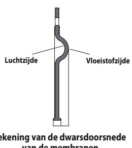
Tekening van de dwarsdoorsnede van de membranen
