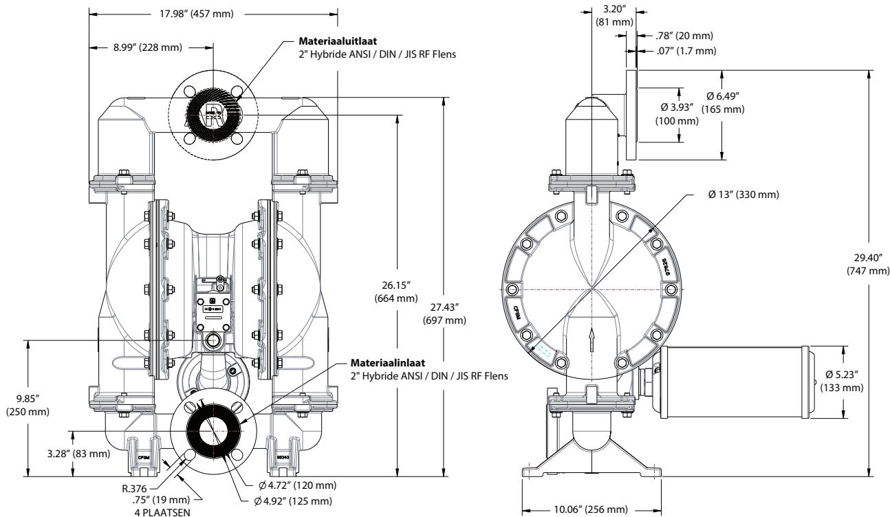
Afmetingen worden alleen ter referentie weergegeven, ze worden in inches en millimeters (mm) weergegeven.
