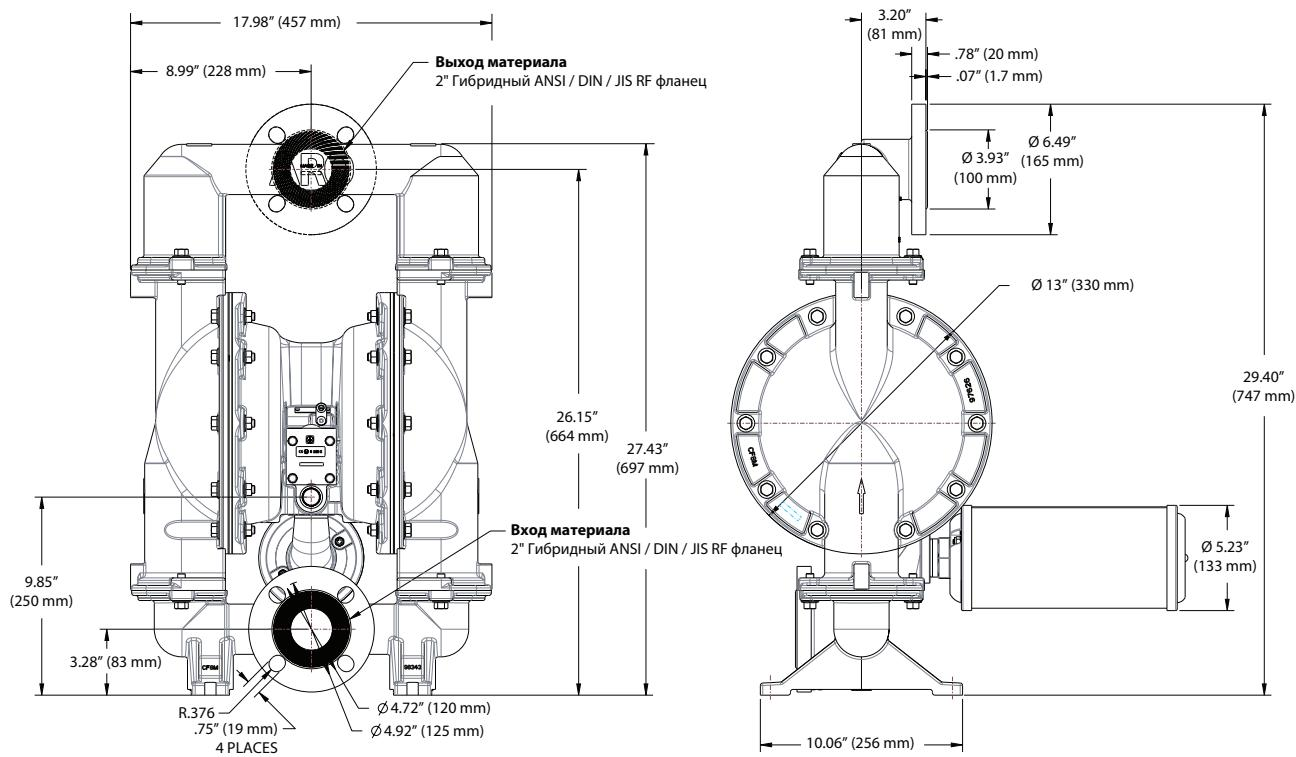
(Указанные размеры приведены только для справки, они отображаются в дюймах и миллиметрах (мм).
