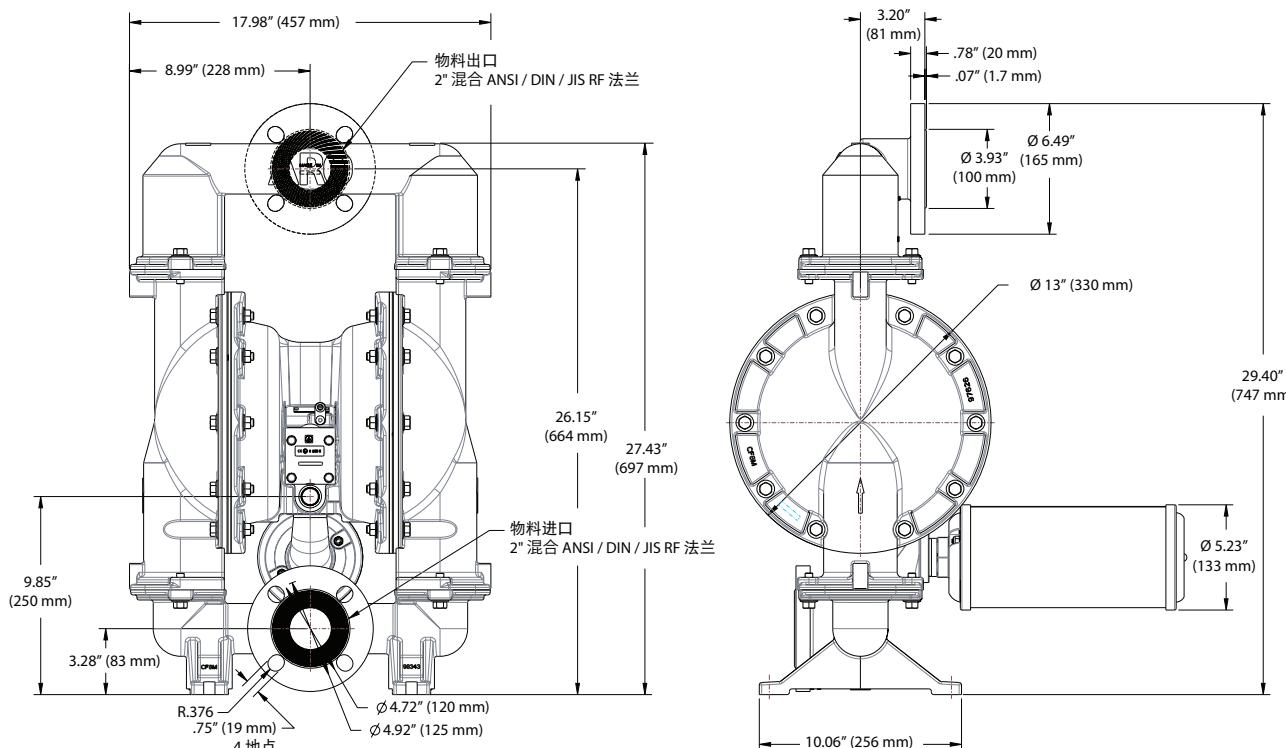
所示尺寸仅供参考, 图示单位为英寸和毫米。
