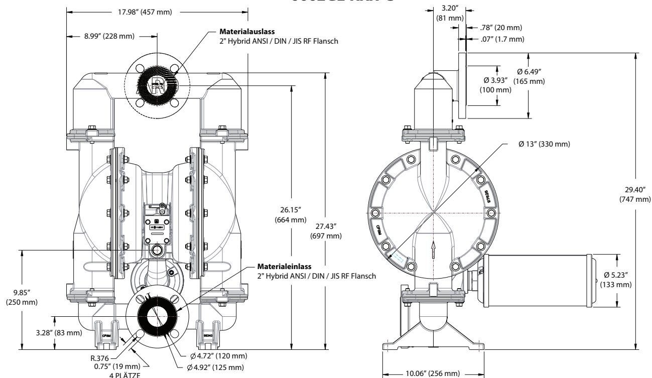
Die angezeigten Maße dienen nur der Bezugnahme, sie sind in Zoll und in Millimetern (mm) angegeben.
