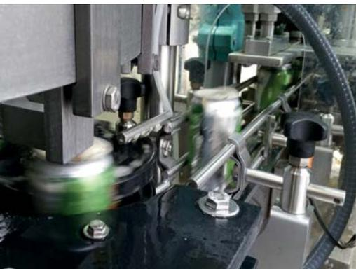
centrífuga proporcionó un aumento significativo en la potencia y la operación requerida en un ciclo continuo. La bomba utilizaba un propulsor para succionar la cerveza y, luego, dispensarla en la llenadora. Después, se transfería el líquido a envases de 12 y 16 onzas. Si la operación tenía que detenerse, el propulsor continuaba girando, espumando la cerveza en la llenadora y aumentando la temperatura del líquido. El bombeo constante de la cerveza introducía más oxígeno en
