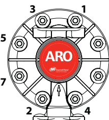
Sekwencja dokręcania
