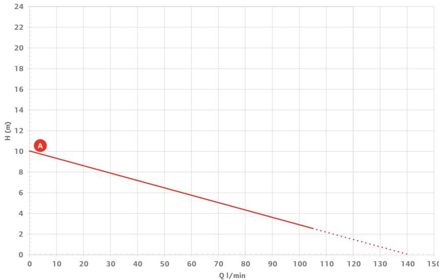
— A (roue axiale avec kit de distribution de type Garage) ····· (Roue axiale sans kit de distribution)
