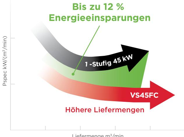
Flachere und längere Kurven für hohe Energieeinsparungen über den gesamten Drehzahlbereich und verschiedene Luftbedarfe.
