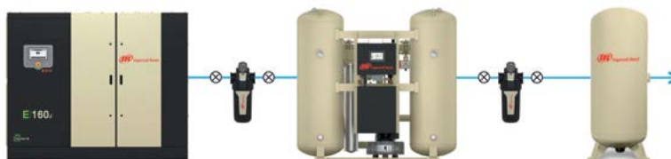
Figure 1.1 Composants clés du système (la tuyauterie de dérivation a été supprimée pour des raisons de simplicité)
