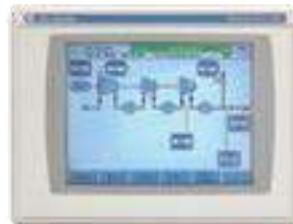
Impiegando un PLC Allen-Bradley® ad architettura aperta, MAESTRO PLC utilizza componenti commerciali che si combinano in modo ottimale agli altri sistemi di controllo e alle migliori pratiche di ogni impianto.
