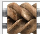
Es kommt zu Rost und Lochfraß und damit schließlich zu beschädigten Rotoren, ineffizientem Betrieb und im schlimmsten Fall zum Ausfall des Kompressors.
