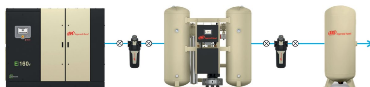
Abbildung 1.1 Hauptkomponenten des Systems (Bypass-Rohrleitungen zur Vereinfachung entfernt)
