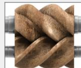
Se desarrollan óxido y corrosión, que provocan daños en los rotores, un funcionamiento ineficiente y posibles averías en el compresor.
