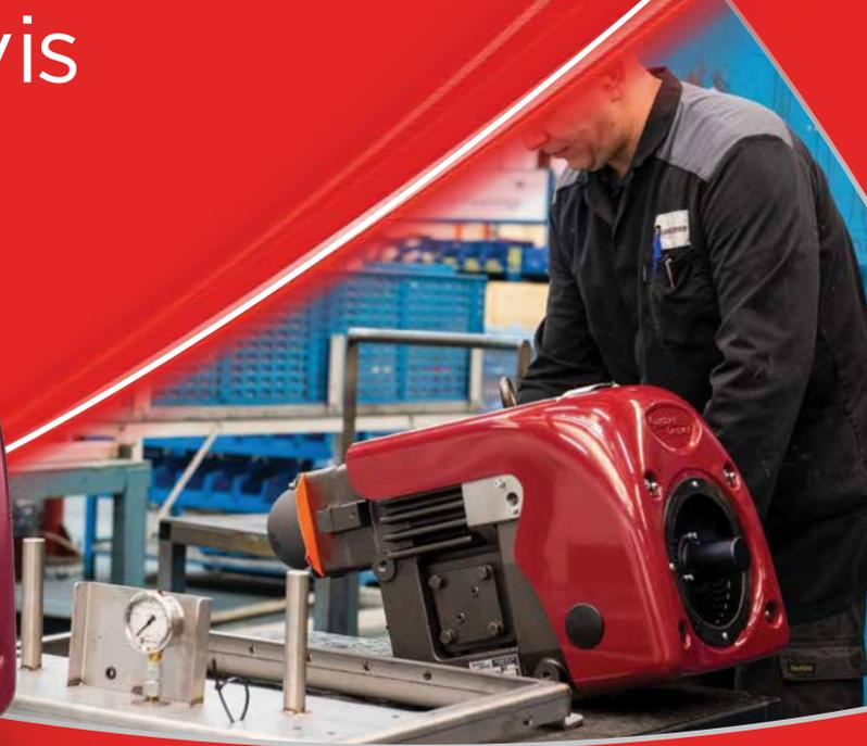
Les compresseurs à vis sèches, sans huile de la série XK offrent une solution robuste, à haut débit, sans contact et à faible maintenance, conçue pour le déchargement sans contamination d'une large gamme de produits secs en vrac. Nos deux modèles XK sont conçus pour pour le déchargement efficace de produits en poudre de haute densité, tandis que notre XK18 est également un compresseur polyvalent, offrant un déchargement cohérent pour une large gamme de produits granulaires.
