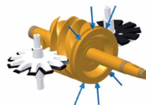
Las cargas radiales actúan tanto en la parte superior como en la inferior del rotor principal.
