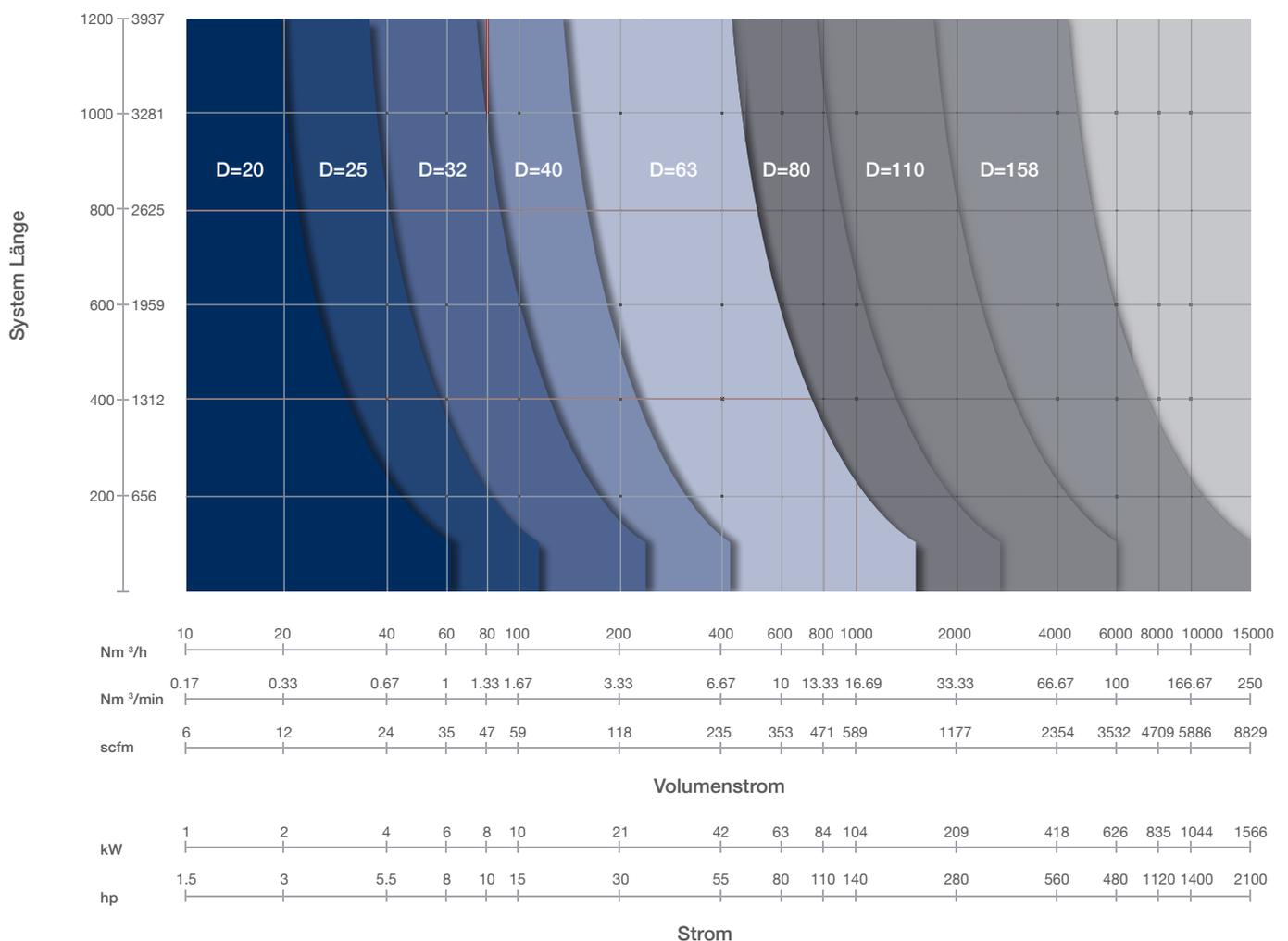
Nur für Referenzzwecke. Basierend auf einem offenen System mit 6,9 bar (100 psig). Bei einem geschlossenen System verdoppelt sich der Volumenstrom.
