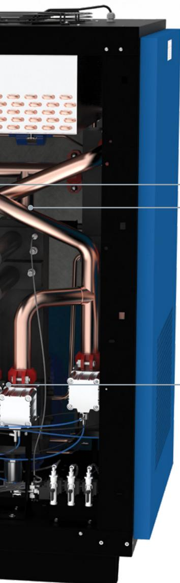
**SÉCHAGE:** L'humidité restante dans l'air n'est alors que de 15% ; l'air pénètre dans l'échangeur de chaleur du sécheur, où il est refroidi et séché à un PDP de  $-20^{\circ}\text{C}$  ( $-4^{\circ}\text{F}$ ). L'humidité extraite commence à former une fine couche de givre sur les parois internes de l'échangeur.
