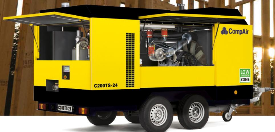
Les compresseurs TurboScrew, avec leur technologie bi-turbo unique, offrent un rendement du diesel inégalé, un poids réduit de 3500 kg et des performances conformes à la directive européenne 97/68/CE Stage V relatives aux émissions et à la préservation de l'environnement. Les nouveaux compresseurs TurboScrew sont dotés du système primé SCRT® (Selective Catalytic Reduction Technology) capable d'éliminer quasiment toutes les émissions d'oxyde d'azote des gaz d'échappement diesel.
