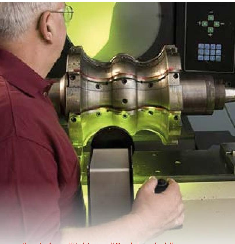
Il controllo qualità di Ingersoll Rand si avvale delle tecnologie più recenti per testare gli strumenti utilizzati per produrre i nostri rotori Sutorbilt Legend.
