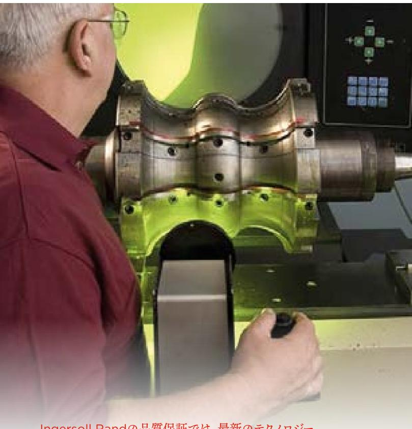
Ingersoll Randの品質保証では、最新のテクノロジー を使用して、Sutorbilt Legendローターの製造に使用 されるツールをテストします。
