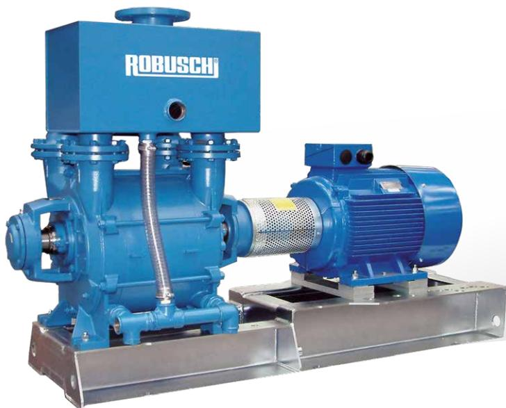
Les systèmes compacts à vide CRVS sont équipés d'une pompe qui est couplée élastiquement directement au moteur électrique, ce qui garantit un alignement parfait et un fonctionnement durable et efficace. Le système CRVS est doté d'un socle spécialement conçu pour une grande rigidité et des vibrations réduites, ce qui garantit des performances fiables et régulières.
