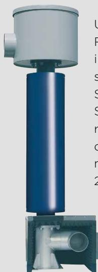
Un kit specifico per i gruppi Robox nel funzionamento in vuoto, composto da silenziatori ad assorbimento SDL e silenziatori di scarico SPS. Questo riduce il livello di rumore generato dalla bocca di scarico di circa 25 dB(A) nel campo delle frequenze da 200 Hz a 20 kHz.
