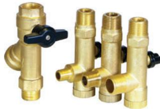
Tous les débris sont retenus par la crépine qui protège le purgeur de tout blocage et réduit l'entretien au minimum. Elle est spécialement conçue pour éviter les restrictions de débit susceptibles de provoquer des sas. Une crépine de protection en ligne spécialement conçue garantit que les débris n'affectent pas l'orifice ou les joints de la valve et permet au technicien de service de fermer en toute sécurité le purgeur du système d'air comprimé.
