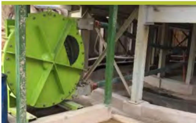
En Afrique du Sud, Albin Pump® a fourni 2 ensembles de pompe ALH125. Ces derniers sont réglés à 55 m³/h chacun (25 tr/min) et ne subissent pas d'usure abrasive excessive. La durée de vie du tuyau est principalement liée à la vitesse de la pompe. Nos pompes ALH125 fonctionnent en continu 24 h/24 et 7 j/7, et la durée de vie du tuyau dépasse les attentes du client.
