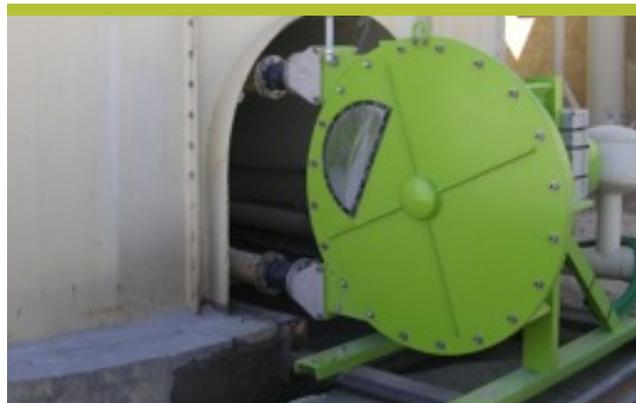
Il funzionamento lento della nostra pompa, combinato con il tubo in gomma naturale, prolunga la durata del tubo. I nostri tubi in gomma naturale sono progettati per gestire liquidi abrasivi alla perfezione.
