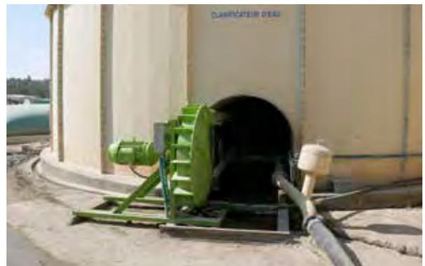
ALH100 bombeando com vazão reduzida do espessador em uma pedreira
