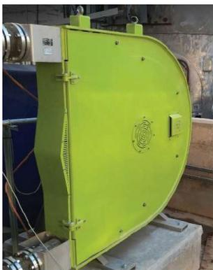
permettent d'augmenter considérablement la durée de vie du tuyau mais aussi de réduire la consommation d'énergie. Avec des débits élevés allant jusqu'à 150 m<sup>3</sup>/h (660 gpm), l'ALX150 est l'une des pompes péristaltiques offrant le plus de débit au monde avec une seule tête. Elle ne nécessite donc pas l'utilisation de configurations multi-têtes qui augmentent les coûts d'acquisition et de maintenance.
