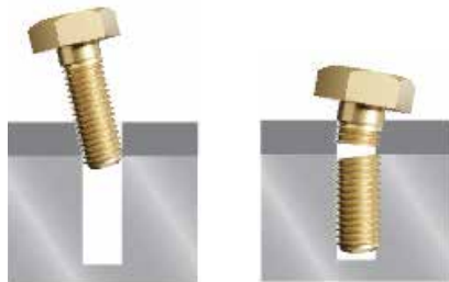
Désalignement Attache cassée
