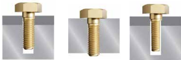
Attache flottante Pièce manquante Fil endommagé
