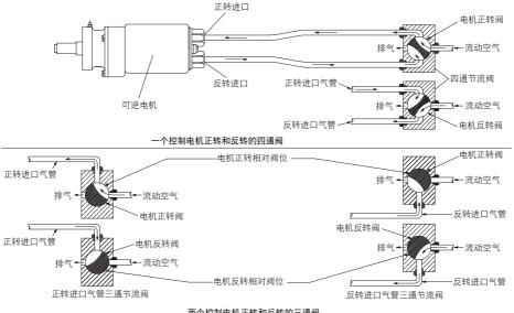
两个控制电机正转和反转的三通阀
