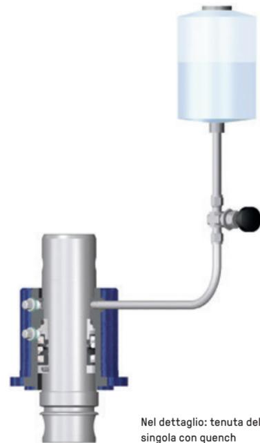
Nel dettaglio: tenuta dell'albero singola con quench
